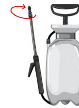
Régler la buse en faisant une rotation
