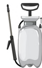
Retirer la pression en tirant la soupape
